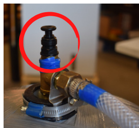
Luftningsventil på extra tanken (om du har beställt en extra tank)
